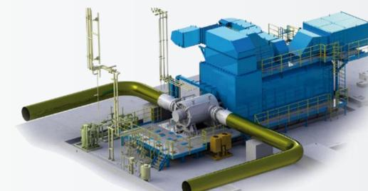
Турбоблок ГПА с системой охлаждения
