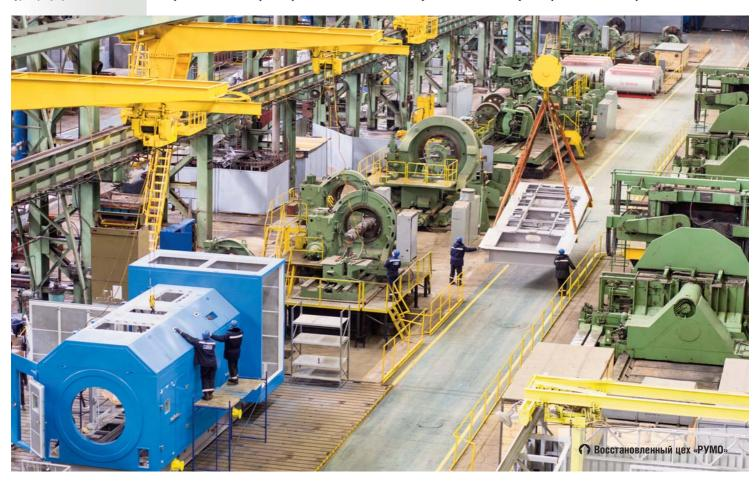
АО «РУМО» расположено в Нижнем Новгороде на территории площадью 9 гектаров. Предприятие имеет собственные производственные площади 61 000 м²: цех механической обработки, сварочно-заготовительный цех, сборочно-складской цех и участок испытательных установок для проведения испытаний газомотокомпрессоров, поршневых компрессоров и двигателей внутреннего сгорания на различных видах топлива.
