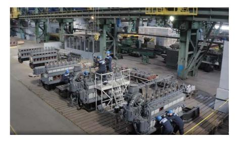
В настоящее время АО «РУМО» готовит к выпуску современные двигатели внутреннего сгорания размерности 22/28, в разном исполнении, работающие на различных видах топлива. Головные образцы двигателей данной размерности имеют 8-цилиндровое газопоршневое исполнение и предназначены для работы на природном газе в составе электрогенераторных установок. Торговая марка таких двигателей — РУМО-502. В настоящее время они проходят
